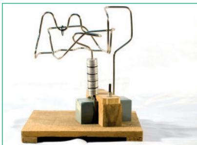
Dexterímetro de Anillos de Moede
